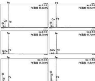
図 3-7 赤色塗膜の表裏 ED-XRF 結果
