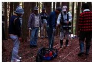
写真5 小型レーダ探査風景
