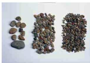
第3路面G 表層構築材(左から礫・礫・砂・礫)
