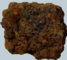
1 SI11 鉄滓の付着した炉壁
