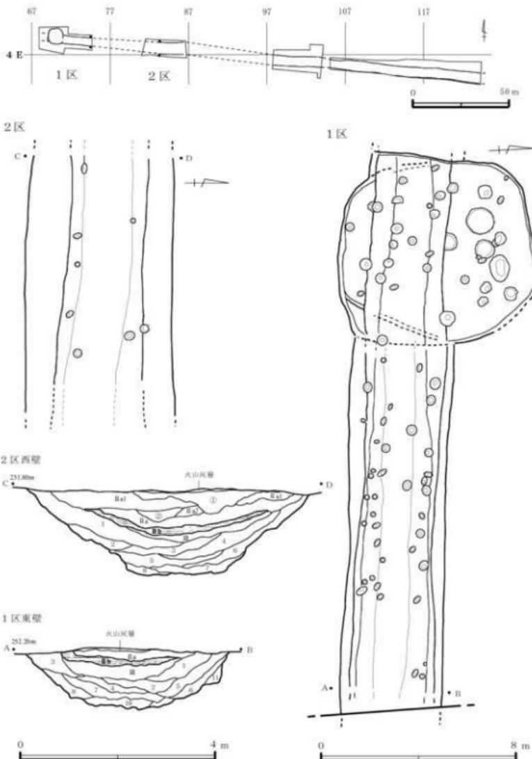
第319図 真光寺原遺跡 M-1号溝実測図(1)
