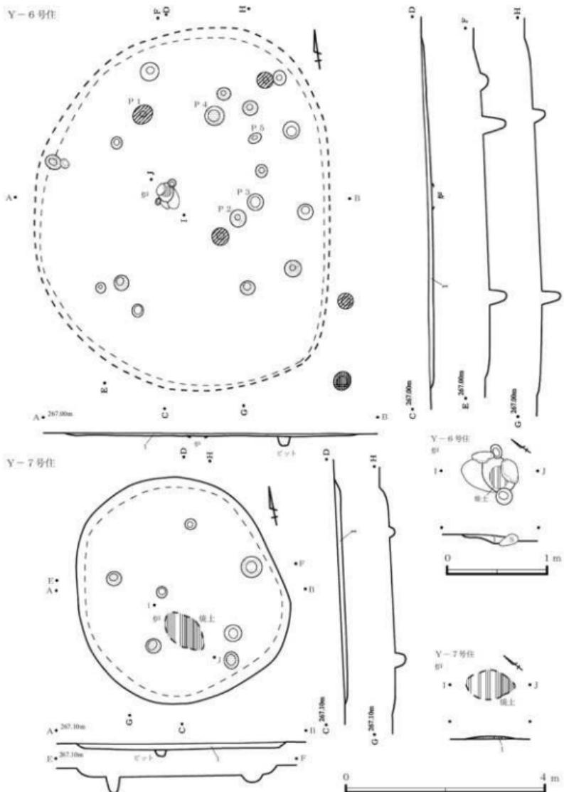
第244図 中野谷原遺跡 Y-6・7号居住址実測図
