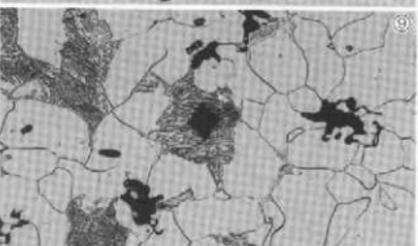
第320図 鋳造鉄片 (ノミ状鉄器再加工) の顕微鏡組織(9)
