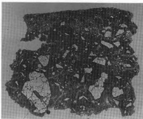
Photo.27 上段：鑄型（外型）（HOM-35）のマクロ組織（ $\times 10$ ）
