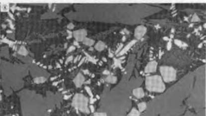
Photo.3 流出孔滓・流動滓の顕微鏡組織
