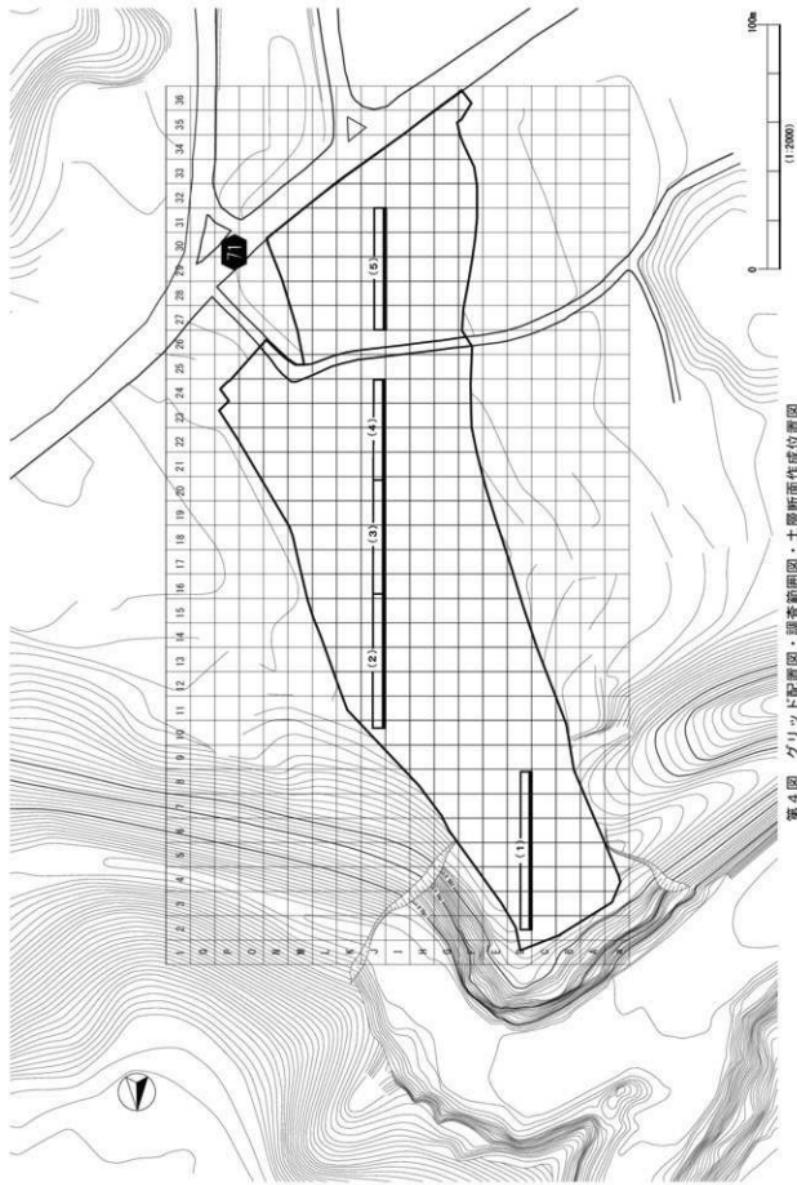
第4図 グリッド配置図・調査範囲図・土壌断面作成位置図
