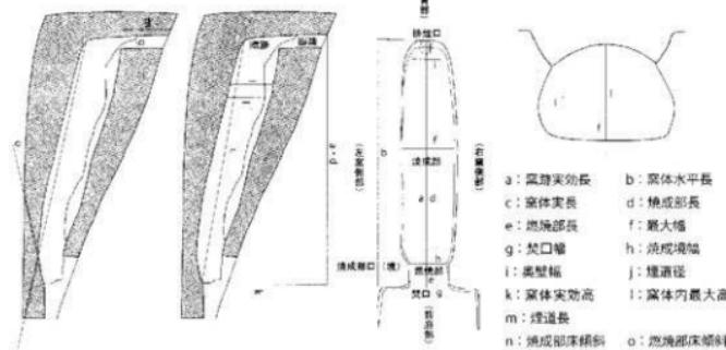
第6図 須恵器窯の名称・計測位置図（能美市教委 2018 より引用・原図は窯跡研究会 2010）
