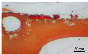
図14-2 P102-2,6-aの塗膜状破片断面
