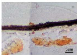
図16-2 P125-6-aの塗膜状破片断面
