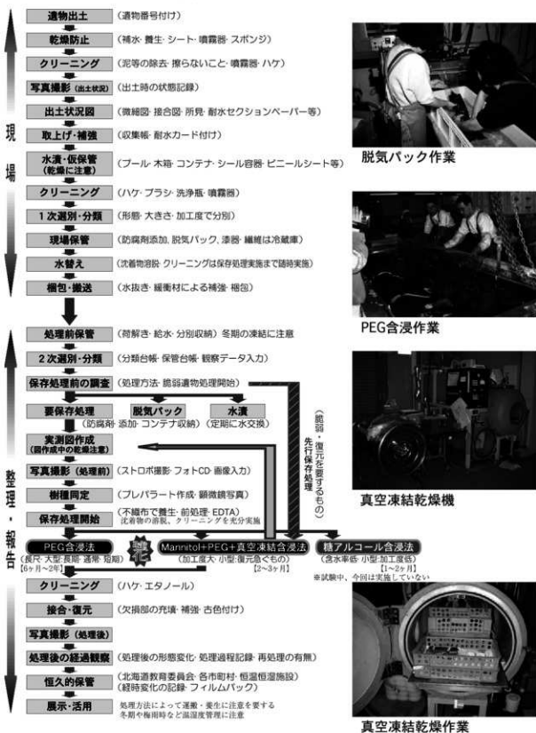
図 - 9 木製品の保存処理工程
