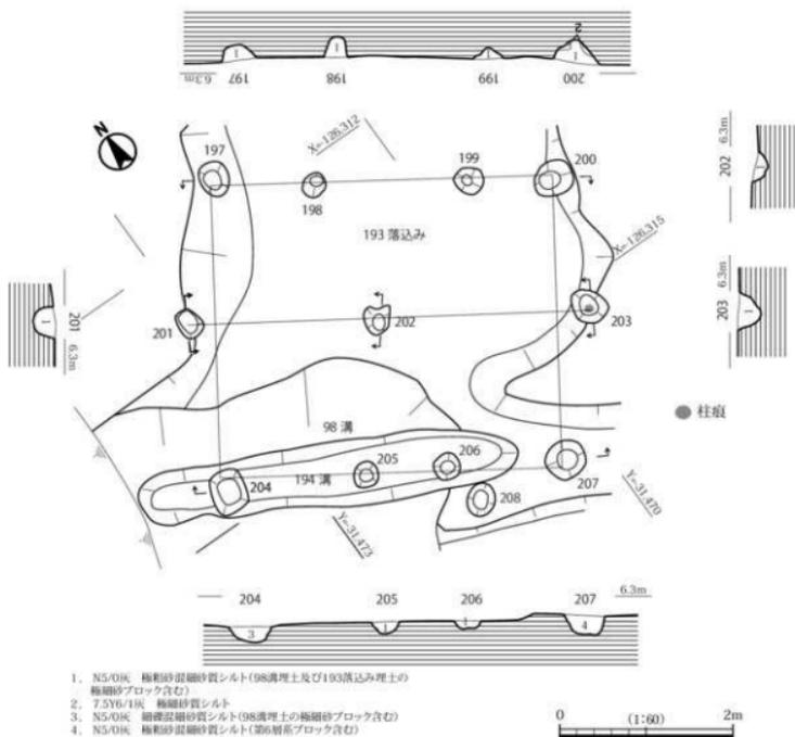
図 38 掘立柱建物 4 平・断面
