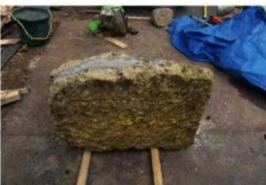
第44図 石材破断面の接着状況
