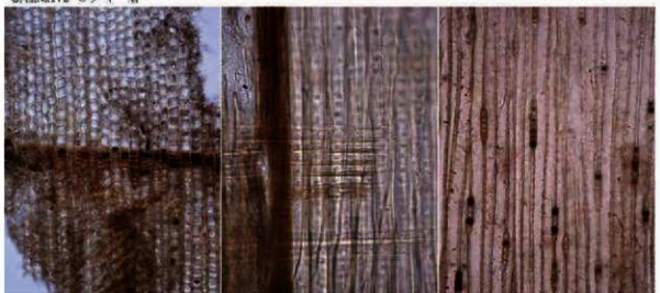
横断面 放射断面 接線断面 樹種No.71-1 ヒノキ 下駄 台
