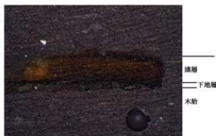
29 No.613底板 塗膜 50 μm
