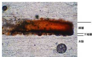
28 No.613底板 塗膜 50 μm
