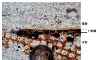
30 No.613底板 塗膜 50 μm
