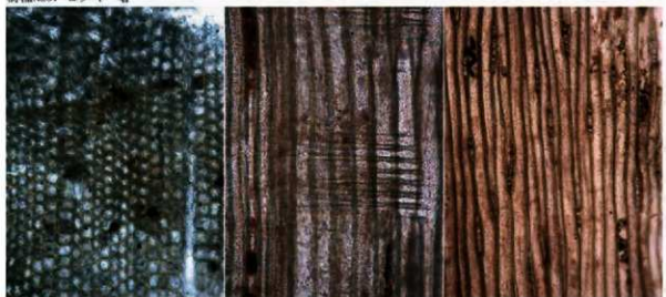
横断面 樹種No.68 ヒノキ科 箸 0.1mm 放射断面 0.1mm 接線断面 0.1mm
