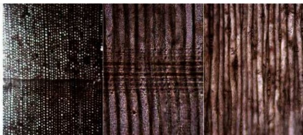
横断面 放射断面 接線断面 樹種No.69 ヒノキ 箸
