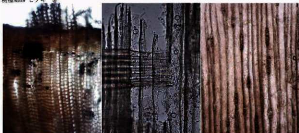
横断面 放射断面 接線断面 樹種No.172 ヒノキ 箸
