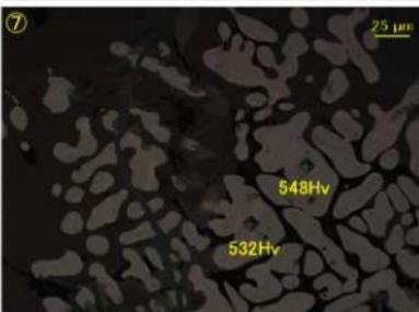
Photo. 20 梶形鍛冶滓の顕微鏡組織
