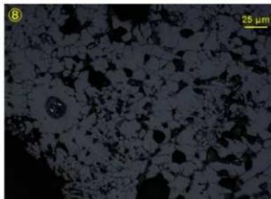
Photo. 10 粒状滓の顕微鏡組織
