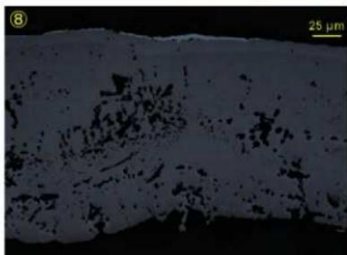
Photo. 11 鍛造剥片の顕微鏡組織
