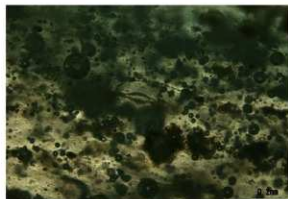
写真 12 No.5 散在した気泡
