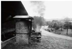
写真3 排煙口からの黒煙・炎（開始72時間後）
