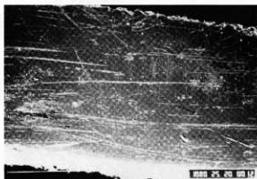
走査型電子顕微鏡写真 約X53 彫刀面
