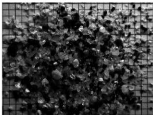
写真1 SD02 覆土断面・試料2 (落射光) わずかに灰色をおびた白色のスポンジ状 軽石型ガラスがごく少量含まれている。 背後は1mmメッシュ。
