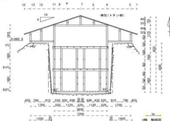
図39 東西軸組図(d軸)
