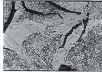
写真5 高木遺跡 試料NoFB1000003 鉄滓の組織写真(ナイタル腐食)
