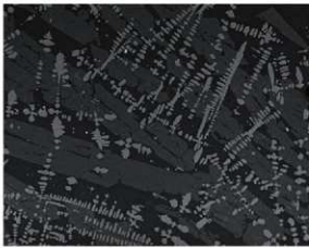
写真9 高木遺跡 試料NaFBI000007 鉄滓の組織写真
