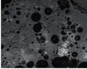
写真9 高木遺跡 試料NaFBI000007 鉄滓の組織写真
