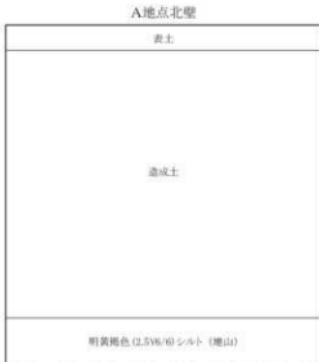
図 55 A・B地点土層断面柱状図
