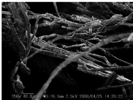
ブロック 不詳 構成糸繊維 ほぼ単繊維に分離された状態
