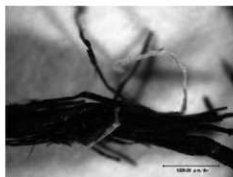
写真5 分析資料⑤のタテ糸と想定される細い糸から採取した繊維の顕微鏡画像
