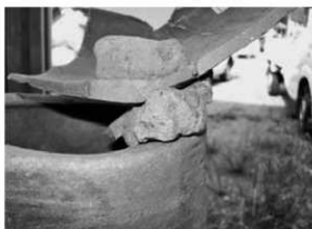
写真11 粘土トチンと匠鉢の取り付け具合
