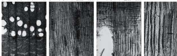
10 a キハダ属 木口×40 b キハダ属 板目×100 c キハダ属 柱目×100 d らせん肥厚
