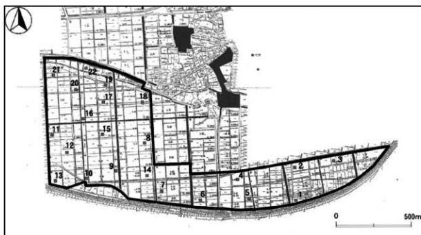
第7図 轟地区農地集積加速化基盤整備事業 試掘坑配置図
