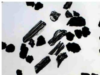
写真2 基本土層・試料41 (透過光) 中央・中央下・中央左上：繊維束状軽石型 ガラス。 中央右上（有色鉱物）：斜方輝石。
