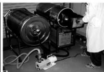
NAD10樹脂含浸タンク
