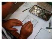
図6 漆膜分析のための微小破片の樹脂包埋作業
