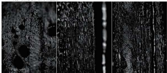
横断面 0.1mm 放射断面 0.1mm 接線断面 0.1mm コナラ属コナラ節 試料番号8 IIIH-1 床面
