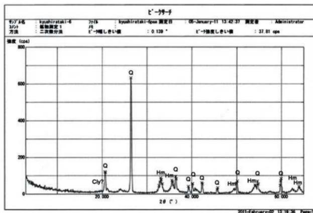
試料No.6 のXRD結果。Q：石英、Hm：赤鉄鉱（Hematite）、Cly：粘土鉱物。
