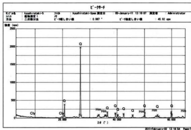
試料No.5 のXRD結果。Q：石英、Hm：赤鉄鉱（Hematite）、Cly：粘土鉱物。
