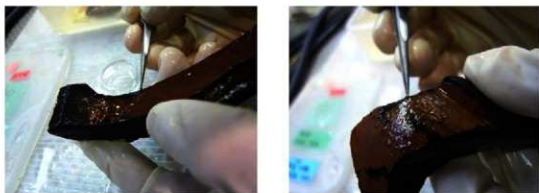
図 138. 漆塗碗 No.28 の塗膜採取箇所 (左図：28-内茶、右図：28-外茶)
