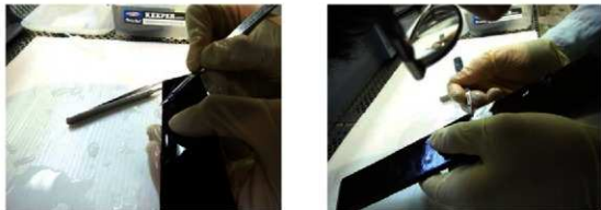
図 43. 漆塗隅切箱物蓋 No.9 の塗膜採取箇所（左図：09-内黒、右図：09-外黒）
