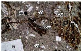
2. グループA 試料29 凝灰岩 蔵2石垣東側 S222 デイサイト質ガラス質凝灰岩
