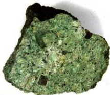
7. 石廟の屋根 炉1 試料63 デイサイト質ガラス質凝灰岩
