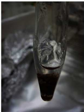
写真3 試料 No.1に見られた透明なゲル状浮遊物
