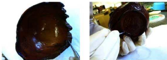
図 6. 漆塗碗 No.2 の塗膜採取箇所（左図：02-内赤、右図：02-外赤）
