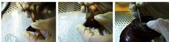
図 173. 漆塗碗 No.35 の塗膜採取箇所 (左図：35-内赤、中図：35-外赤、右図：35-底黒)
