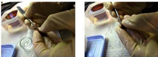
図 78. 漆塗碗 No.16の塗膜採取箇所(左図: 16-内赤、右図: 16-外赤)
