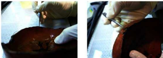
図 16. 漆塗碗 No.4 の塗膜採取箇所 (左図：04-内赤、右図：04-外赤)
