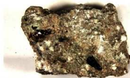
8. 原産地試料 笏谷石 試料64 デイサイト質ガラス質凝灰岩
