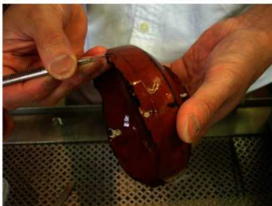
写真1 漆塗製品から漆試料の採取
