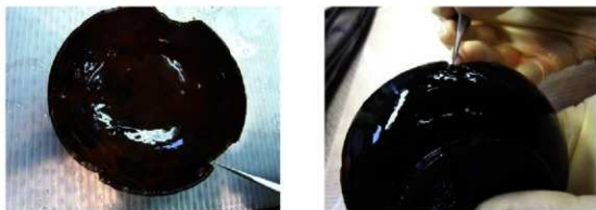
図 103. 漆塗碗 No.21 の塗膜採取箇所（左図：21-内赤、右図：21-外黒）
