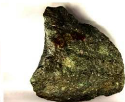
8. 原産地試料 笏谷石 試料64 デイサイト質ガラス質凝灰岩
