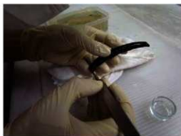
図 178. 漆塗櫛 No.36 の塗膜採取箇所 (36-赤黒)
