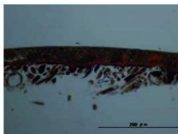
図 182. 漆塗樹 No.36 の塗膜断面落射観察画像 (36-赤黒)
