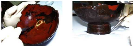
図 1. 漆塗碗 No.1 の塗膜採取箇所（左図：01-内赤、右図：01-外黒）
