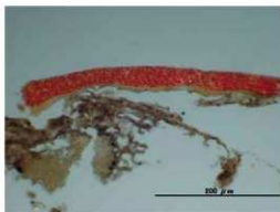
図 57. 漆塗箸 No.11 の塗膜断面落射観察画像 (11-赤)
