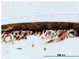
図 181. 漆塗櫛 No.36 の塗膜断面透過観察画像 (36-赤黒)
