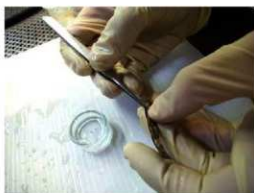
図 194. 漆塗底板 No.39 の塗膜採取箇所 (39-黒)
