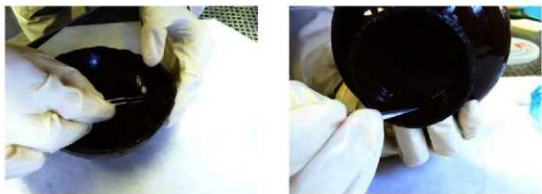
図 21. 漆塗碗 No.5 の塗膜採取箇所 (左図：05-内赤、右図：05-外赤)
