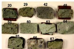
10. 原産地試料 豊岡 試料66 デイサイト質火山礫凝灰岩
