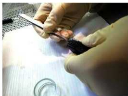
図 58. 漆塗部材 No.12 の塗膜採取箇所 (12-黒)
