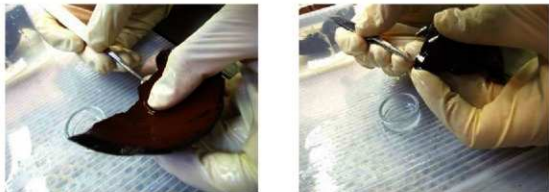
図 118. 漆塗碗 No.24 の塗膜採取箇所（左図：24-内赤、右図：24-外黒）
