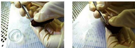
図 168. 漆塗腕 No.34 の塗膜採取箇所 (左図：34-内赤、右図：34-外赤)
