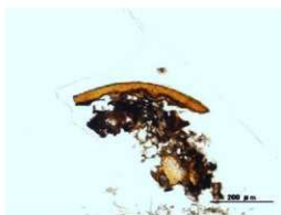
図 51. 漆塗箸 No.10 の塗膜断面透過観察画像（10-黒）
