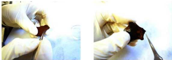
図 158. 漆塗腕 No.32 の塗膜採取箇所（左図：32-内赤、右図：32-外黒）
