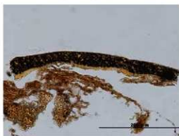
図 56. 漆塗箸 No.11 の塗膜断面透過観察画像 (11-赤)
