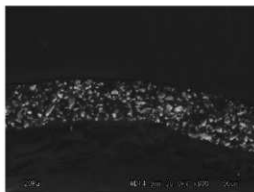
図 204. 漆塗串 No.11 の塗膜断面 SEM 画像 漆塗串 No.11 における朱の粒径は 2.6\sim 8.2\mu\text{m} で、大きさは比較的均質であった（図 204）。
