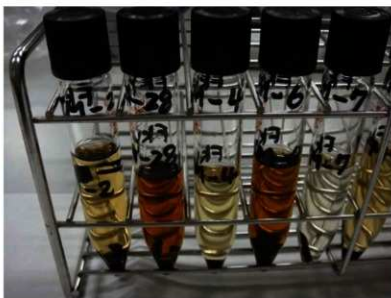
写真 2 遠心沈澱管による漆試料の化学洗浄処理
