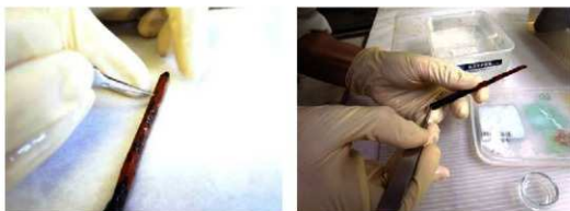
図 83. 漆塗箸 No.17 の塗膜採取箇所（左図：17-赤、右図：17-黒）
