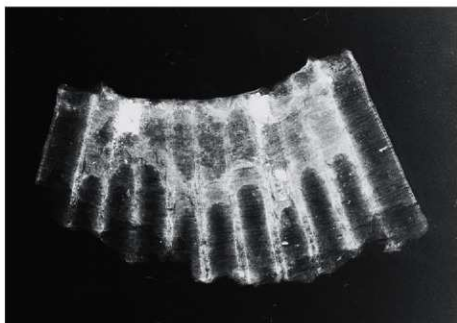
図版1 塗装櫓のX線透視画像 (XCR)
