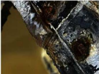
写真1 二式飛行艇と推測される残片（左：全景 右：窓枠に利用されたアクリル）
