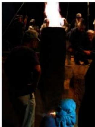
写真2 豎形炉の操業実験
