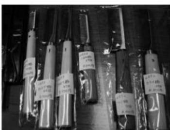
■写真38 熊野筆の製筆で使用する櫛②
