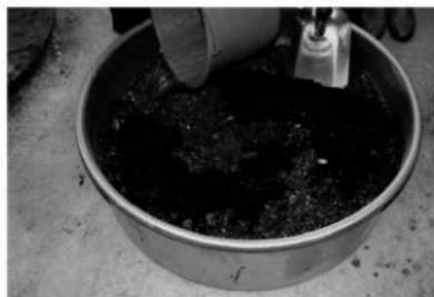
〔写真17〕 藍建ての仕込み、半切り桶に葉（スクモ）と消石灰（元石）を入れる
