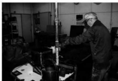
〔写真13〕エアーで染料を吸引して排水
