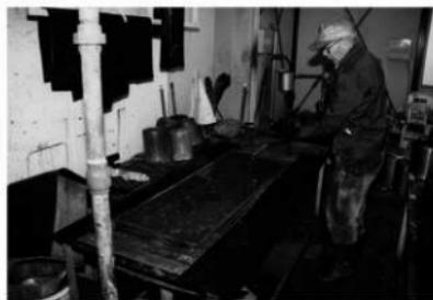
〔写真17〕 注染台での色止め作業
