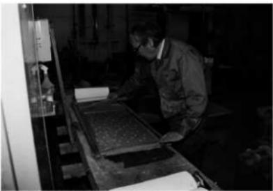
〔写真04〕 型付け（糊置き）作業
