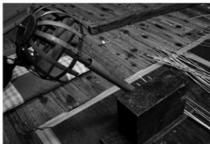
写真62 くす玉の型をはめる台（台座付き） 台座42.5×15cm 厚さ22cm 台部27.2×11.2×17.8cm 筒部44cm 径3.2cm
