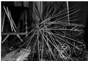
写真65 くす玉の型 床に型を書き代わりにこの型を敷いてその上 からヒゴを組む
