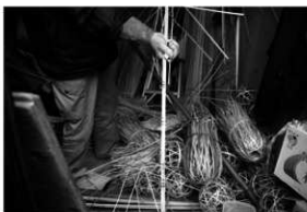
写真68 バカボウ① くす玉のできあがりの寸法が目盛りとして入っている もので、定規より一目で確認しやすい
