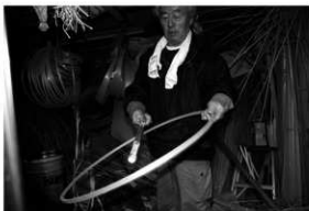
写真71 曲げ輪② バカボウをあてて寸法を確認する
