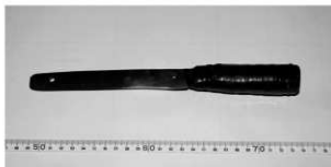
写真58 ナタ (両刃・表面) 全体24.5cm 刃部14.5cm 日本刀を改良したもの
