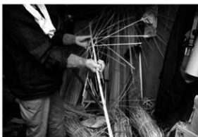
写真69 バカボウ② 寸法を確認する
