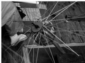
写真94 型に下組みしたくす玉をはめて器具で固定する
