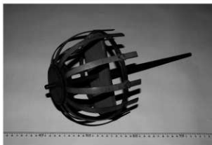
写真60 くす玉の型 (6寸用) 全体41.5cm 球形部15cm 径19.5cm
