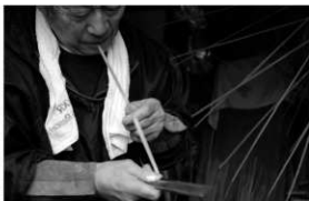
写真85 竹を途中までさいたら口にくわえて一気に がす
