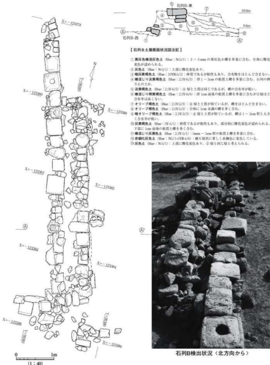
第25図 石列B検出状況及び土層堆積状況図(S=1/40)
