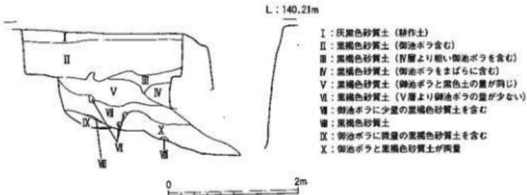
第6図 竪坑土層断面図
