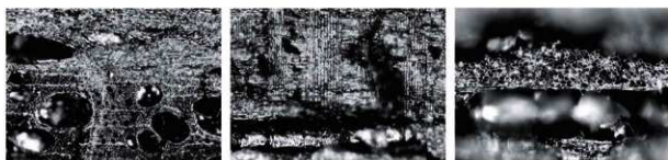
横断面 ————— : 0.4mm 放射断面 ————— : 0.4mm 接線断面 ————— : 0.2mm 3. OK-5 SP5 コナラ属コナラ節
