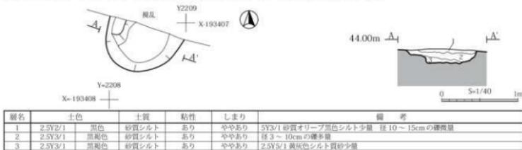
第48図 SK14 土坑平面図・断面図
