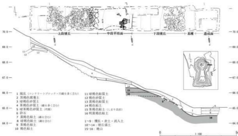
Fig.16 3トレンチ実測図
