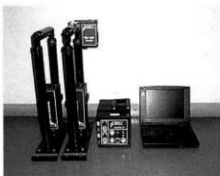
Fig.228 地中レーダーの測定装置
