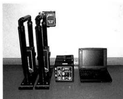
Fig.228 地中レーダの測定装置
