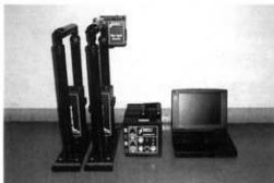
Fig.111 地中レーダの測定装置
