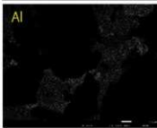
第180図 椀形鍛冶滓 (ASA-9) の顕微鏡組織・EPMA調査結果
