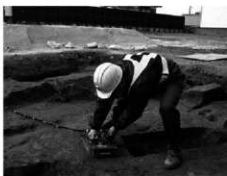
1 地中レーダー探査
