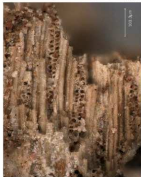
図6 ①合金付着木材（2細胞幅の放射組織が並ぶ）
