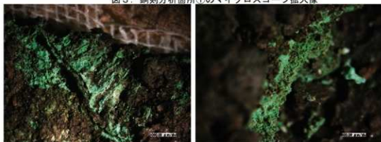
図4. 銅刻分析箇所②(左)、③(右)のマイクログラフ拡大像
