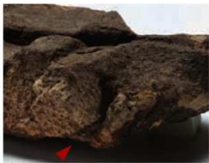
(5) 7号2 塗り込めと鑄型本体に残る帯状の圧痕
