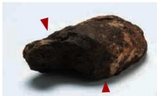
(2) 6号 破断面の帯状の圧痕
