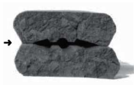
【図版6】側面の開先削り取り
