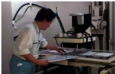
図25 金属製品のX線透過撮影
